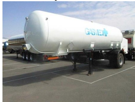
LNG Storage Tank on Trailer
